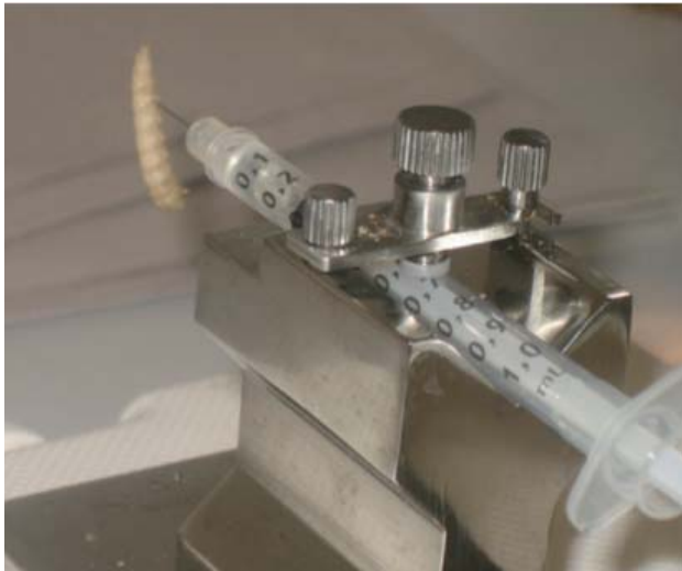
Injektionsapparat zur Infektion von Wachsmottenlarven mit Bakterien.
